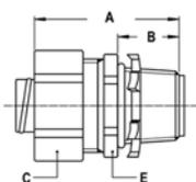
NPT gerade Verschraubung, Aussengewinde, Aluminium
