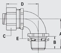
NPT 90° Winkel-Verschraubung, Aussengewinde, Aluminium
